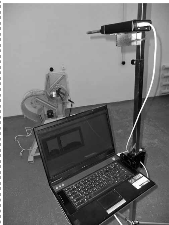
Рис. 3. Специализированное приспособление для проведения исследований по измерению шумовых характеристик
