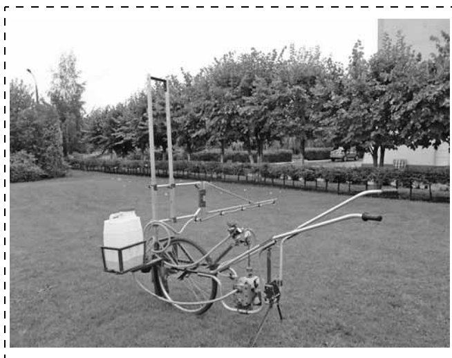
Рис. 1. Малогабаритный штанговый опрыскиватель с уравнивающим механизмом
