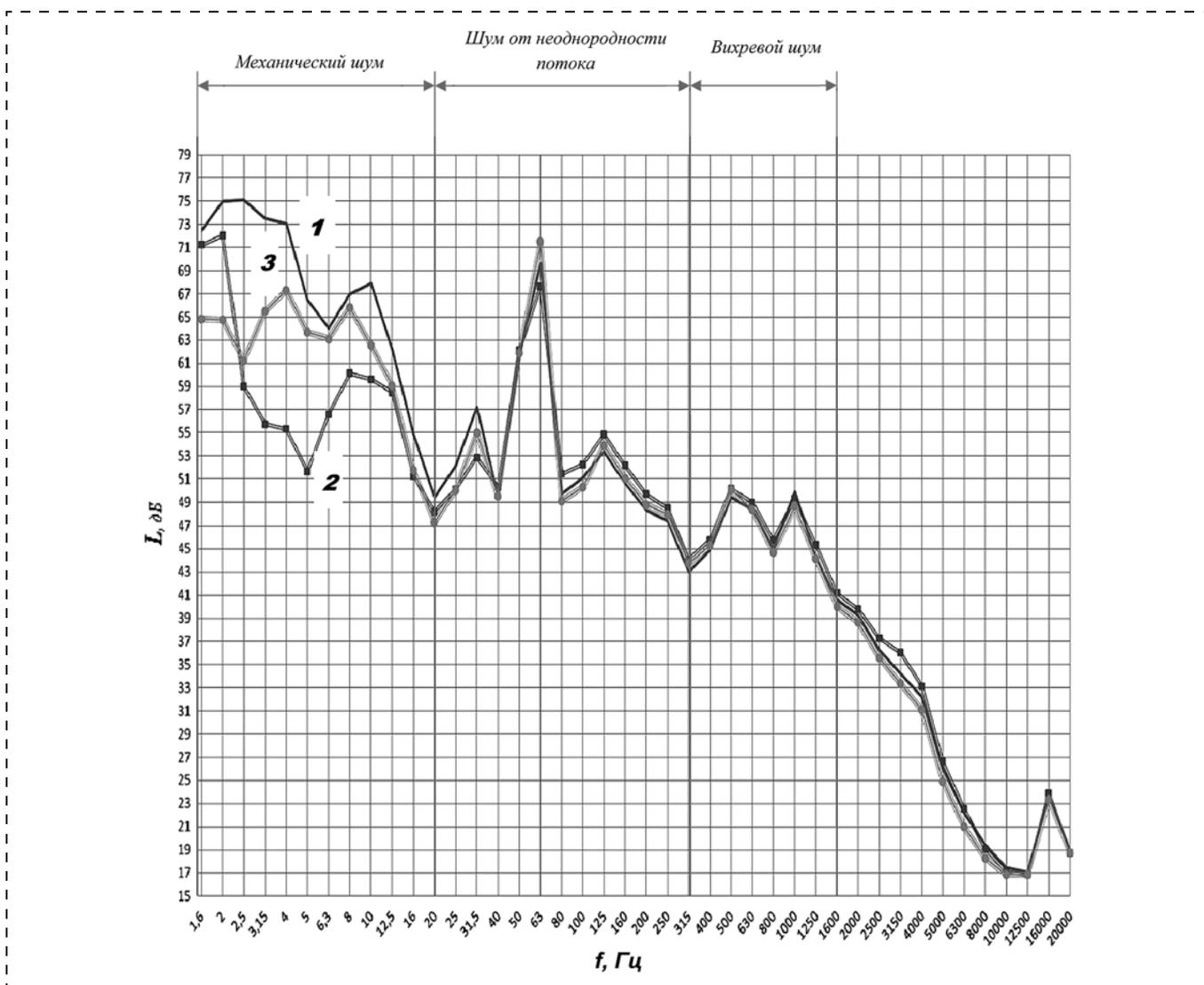
**Рис. 3. Шум вентилятора в зависимости от типа входной решетки при  $n = 600 \text{ мин}^{-1}$ :**
