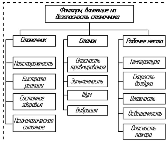
Рис. 1. Факторы, влияющие на безопасность станочника
