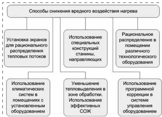
Рис. 2. Способы снижения вредного воздействия нагрева
