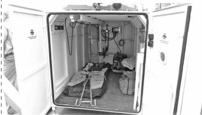
Мобильный подземный реаниматологический комплекс: а — общий вид; б — вид внутри
