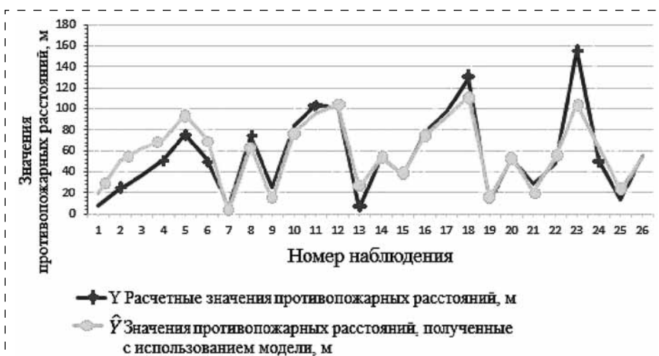
Рис. 6. Сравнение расчетных и модельных значений противопожарных расстояний
