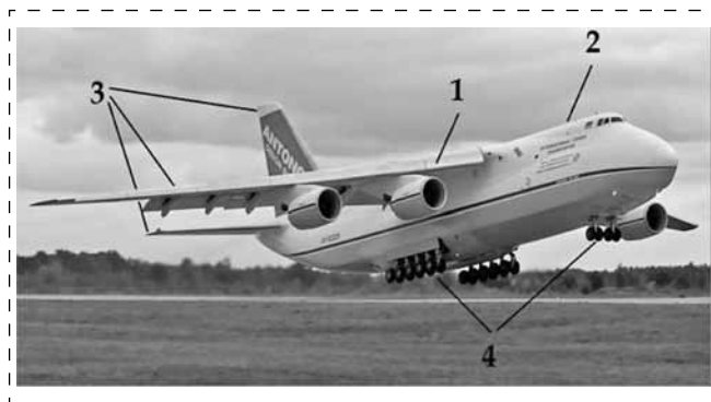
Рис. 2. Зоны возникновения шумов обтекания планера самолета:
