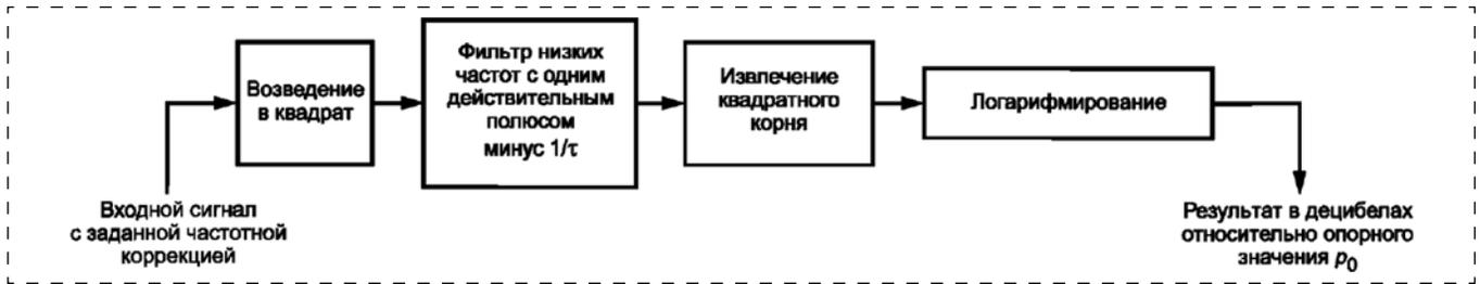
Последовательность обработки сигнала при формировании показаний уровня звука с временной коррекцией
