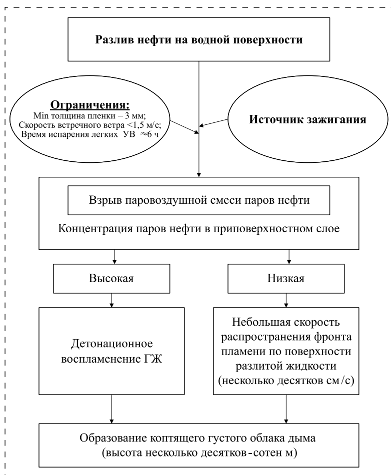
Рис. 4. Схема процесса горения нефтяной пленки на поверхности воды
