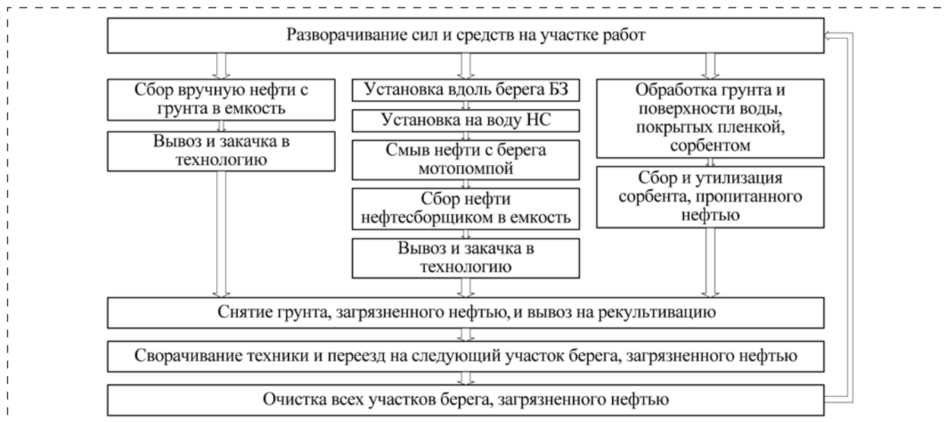
Рис. 6. Технология очистки береговой полосы от нефтяного загрязнения
