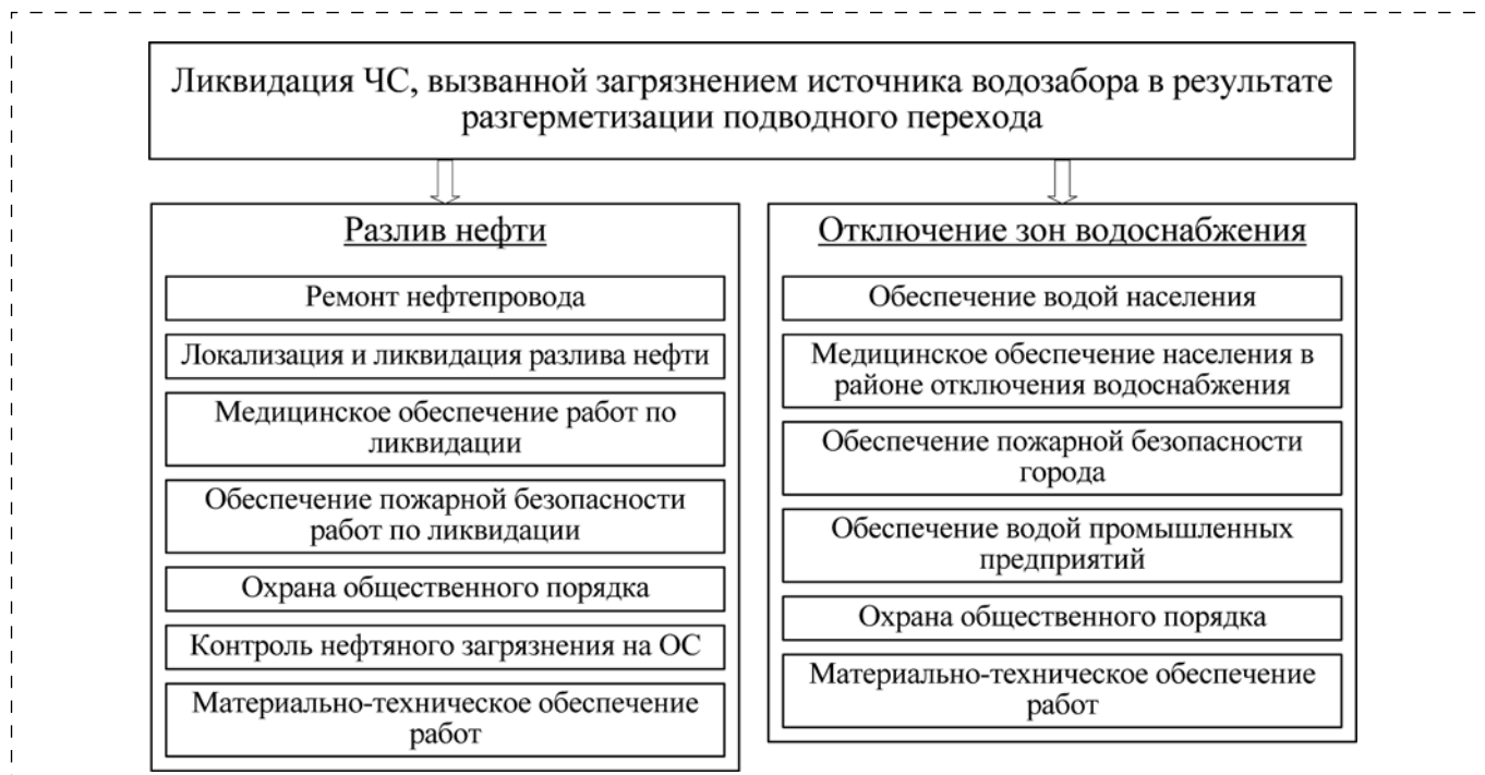
Рис. 5. Комплекс мероприятий по ликвидации ЧС, вызванной разливом нефти с загрязнением источника водозабора в результате разгерметизации подводного перехода
