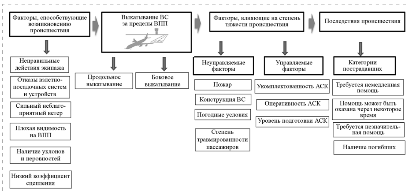
Рис. 1. Модель развития авиационного происшествия "Выкатывание ВС за пределы ВПП"
