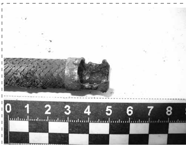
Рис. 1. Локальные термические поражения гибкого газового шланга
