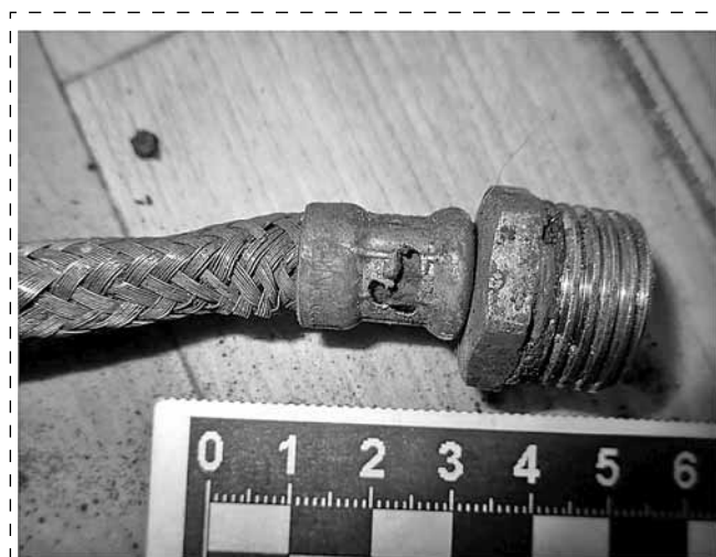
Рис. 2. Проплавление втулки газового шланга
