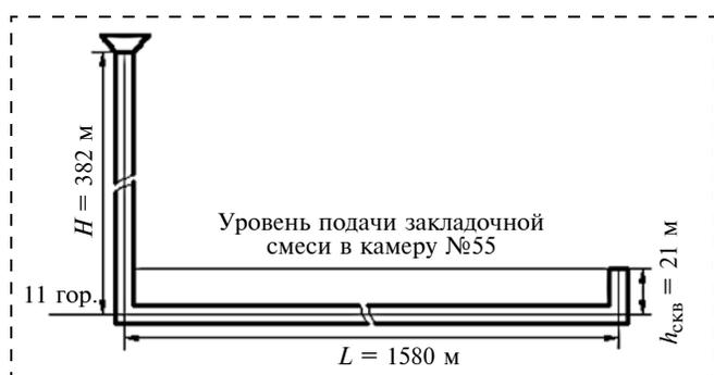
Рис. 1. Схема транспортирования закладочной смеси в камеру № 55 Родниковой рудной зоны Малеевского месторождения
