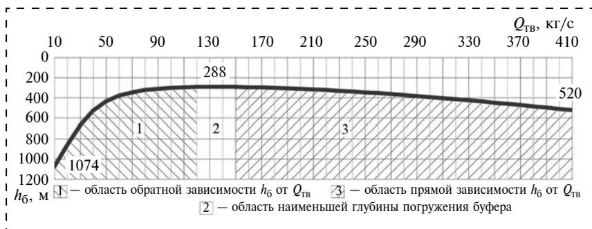
Рис. 3. Зависимость  $h_b$  от  $Q_{\text{ТВ}}$  при диаметре трубопровода 0,4 м
