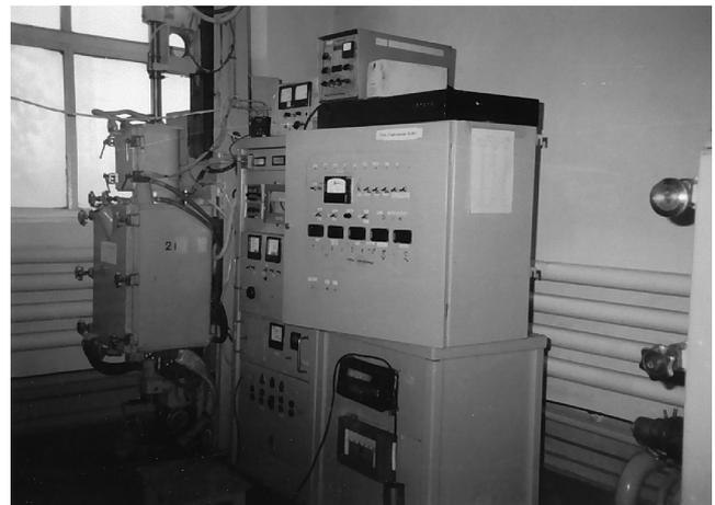
Рис. 2. Общий вид микропроцессорной установки вытягивания германия на основе контактного метода измерения диаметра
