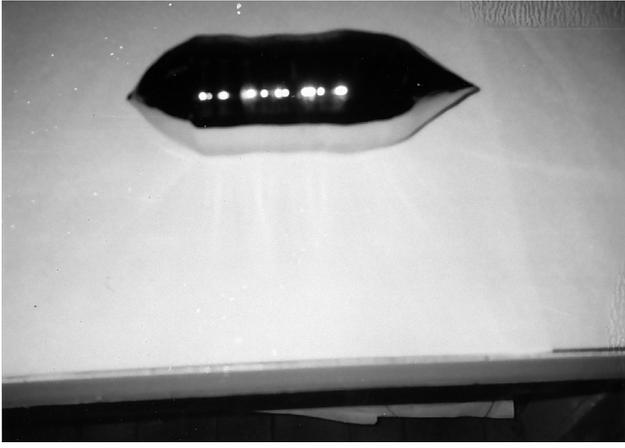
Рис. 3. Слиток германия диаметром 104 мм
