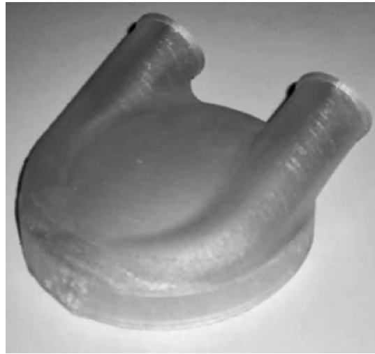
Рис. 5. Опытный образец ИЖС, полученный методом лазерной стереолитографии
