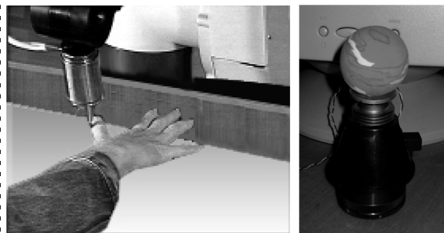
Рис. 4. Безопасное взаимодействие с роботом, оснащенным силомоментным сенсором
