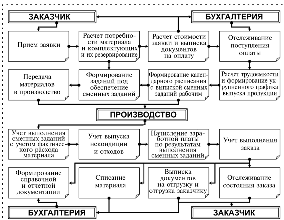
Рис. 2. Функциональная схема управления производственной деятельностью в "ИСУП-Маяк"
