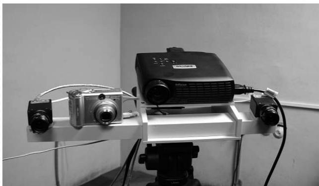
Рис. 8. Внешний вид системы бесконтактных измерений для анализа асимметрии лиц
