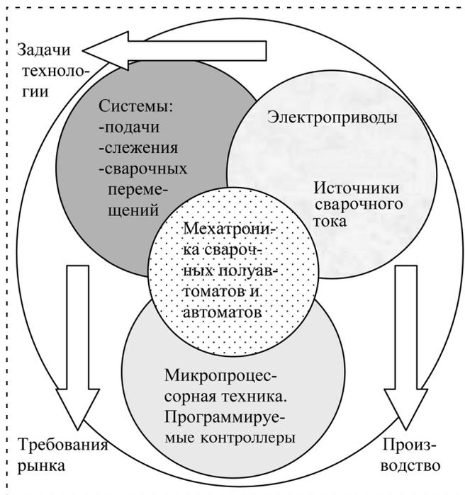
**Рис. 1.** Представление механизированного и автоматизированного дугового сварочного оборудования в виде мехатронной системы
