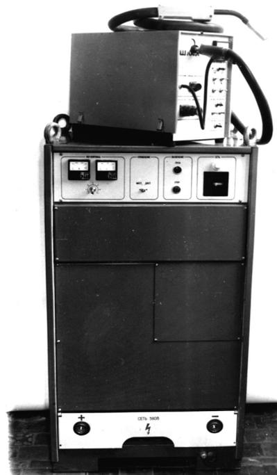
**Рис. 4. Полуавтомат ПШ107А из гаммы полуавтоматов блочно-модульной конструкции с применением принципов мехатроники**
