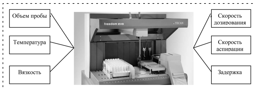
Рис. 3. Пипетирующая станция как объект управления
