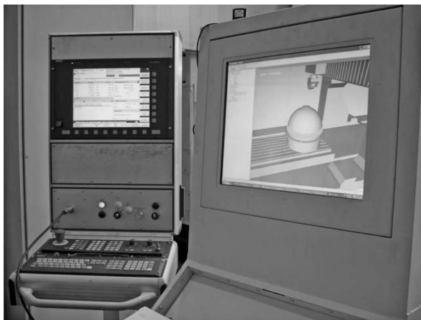
Рис. 4. Общий вид HMI СЧПУ вместе с SatteliteCNC
