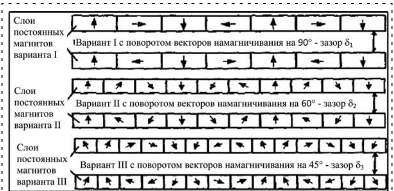
Рис. 4. Картина намагничивания постоянных магнитов в двух близлежащих слоях
