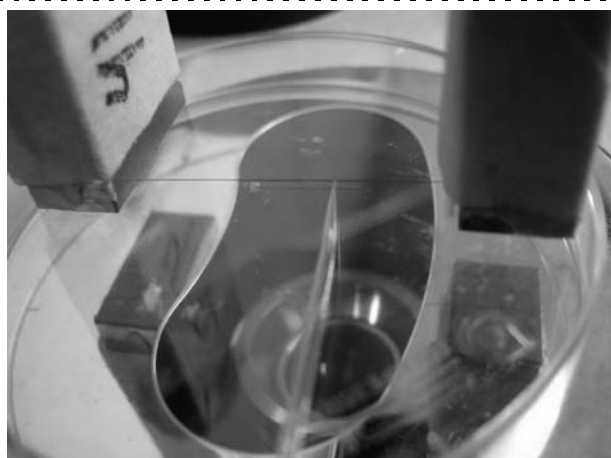
Рис. 5. Контакт микрообъекта с рабочим органом в ходе экспериментов с применением упругой силовой модели
