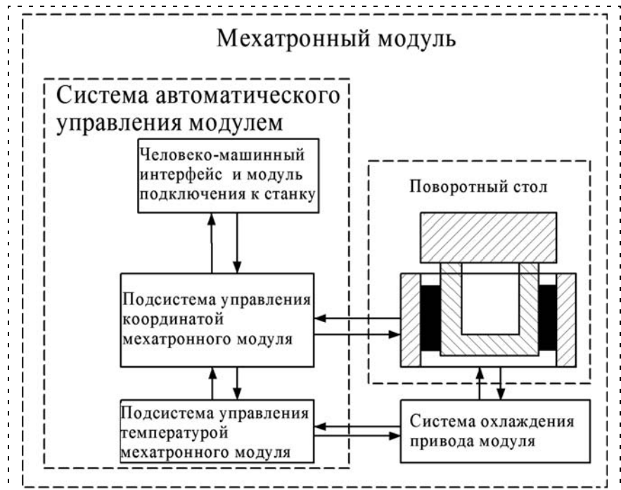
Рис. 1. Функциональная схема мехатронного модуля
