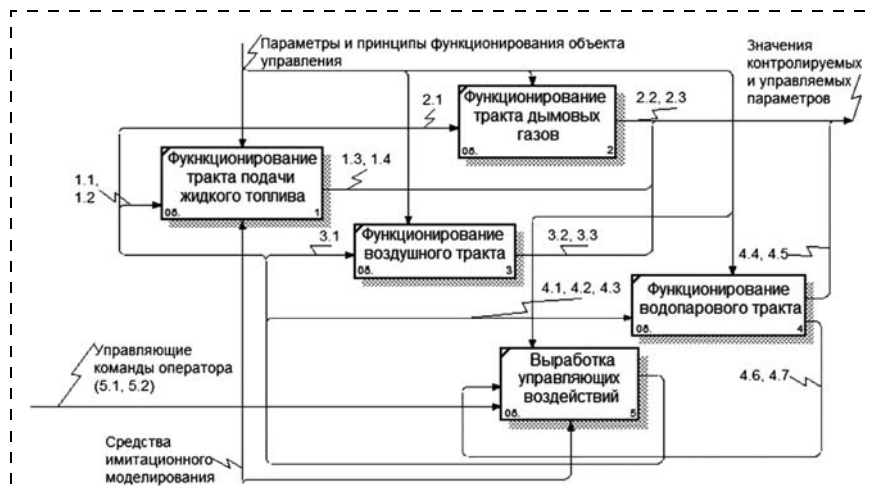
Рис. 3. Функциональная схема имитационной модели котельного агрегата ТГМ-96Б (нотация IDEF0)
