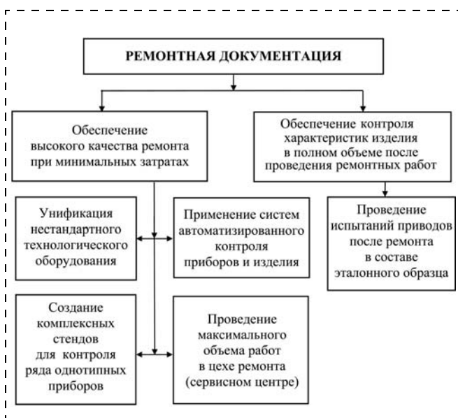
Рис. 5. Требования к ремонтной документации
