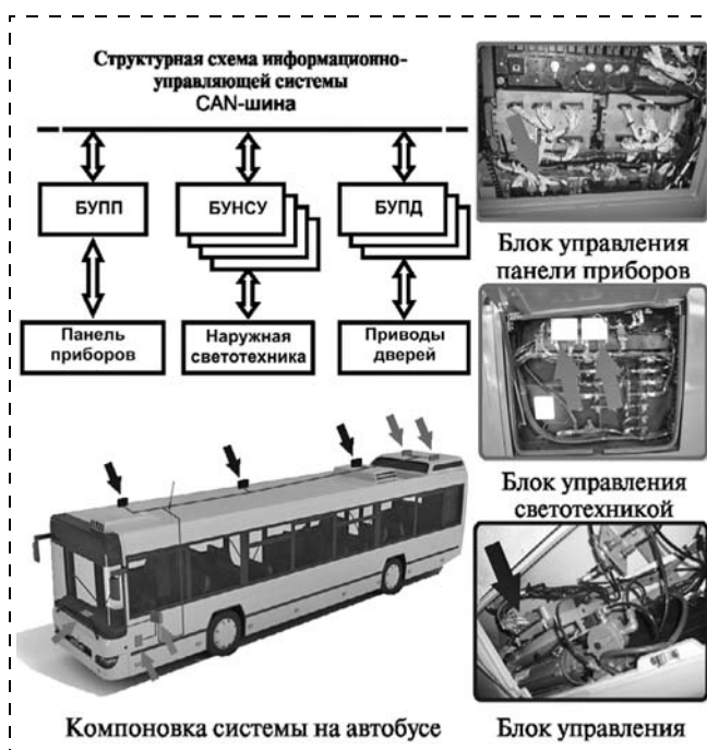
Рис. 5. Структурная схема, внешний вид блоков управления бортовой комплексной многоуровневой информационно-управляющей системы и компоновка системы на автобусах семейства МАЗ
