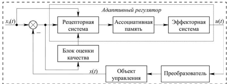
Рис. 5. Система управления с адаптивным регулятором на базе ассоциативной памяти
