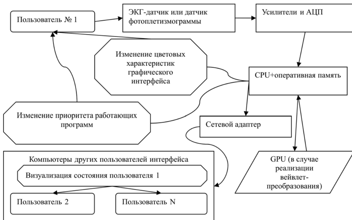
Рис. 3. Схема архитектуры человеко-машинного интерфейса, учитывающего функциональное напряжение пользователя
