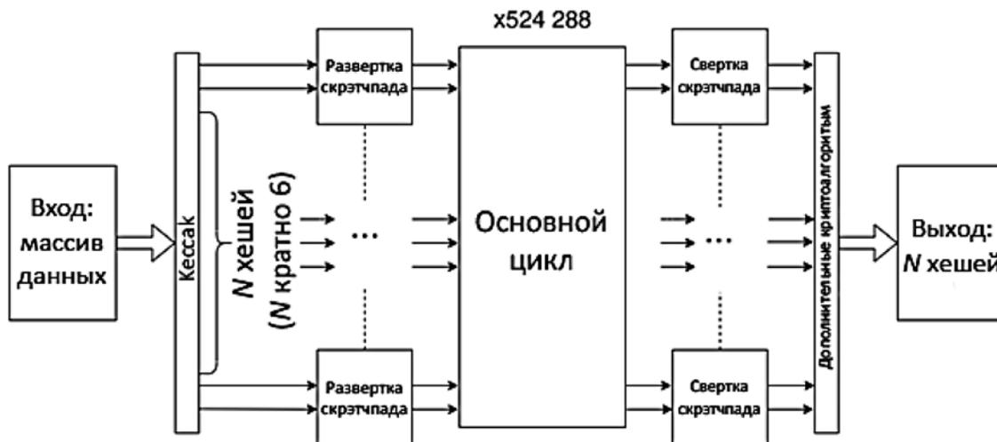
Рис. 3. Схема работы алгоритма с использованием RISC-ядер и SIMD-сопроцессоров
