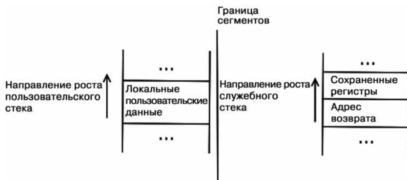
Рис. 2. Разделенные служебный и пользовательский стеки вызовов
