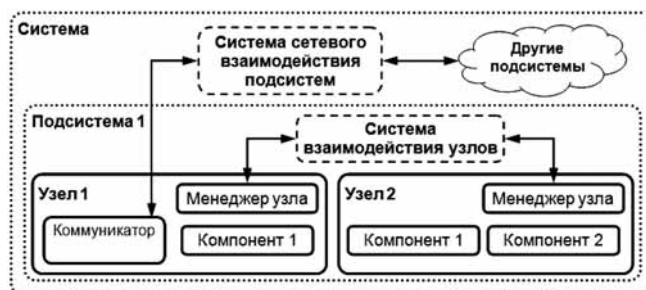
Рис. 1. Структурная схема ИУС МО, основанной на архитектуре JAUS
