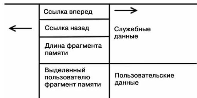
Рис. 3. Традиционная структура элемента списка динамической памяти
