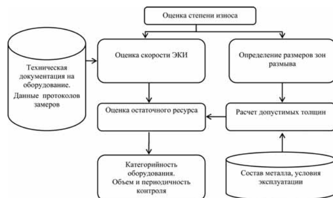
Рис. 7. Методика расчета скорости ЭКИ и остаточного ресурса
