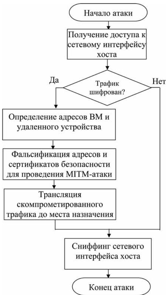
Рис. 8. Обобщенная блок-схема MITM-атаки в ходе тестирования на информационную уязвимость VM со стороны хоста
