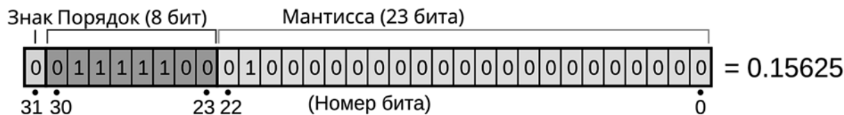
Пример числа с плавающей точкой одинарной точности (изображение распространяется под лицензией CC BY-SA 3.0 Freshenees at the English Wikipedia project, исходный вариант доступен по URL: http://en.wikipedia.org/wiki/File:Float_example.svg )
