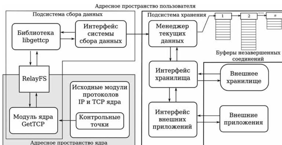
Рис. 1. Архитектура системы GetTCP+
